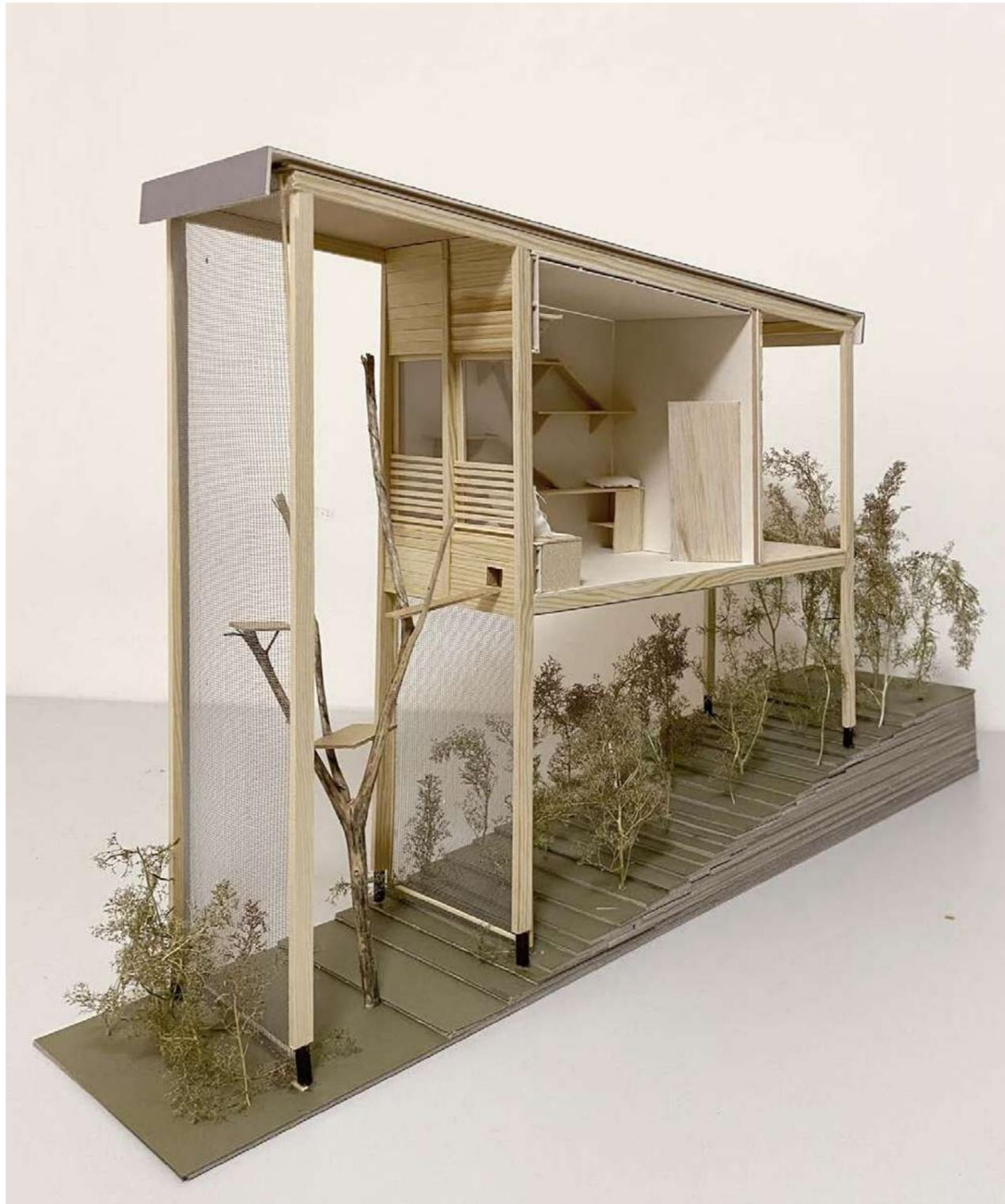
Abb. 62: Schnittmodell des Katzenhaus, mit konstruktiv integrierter Abgrenzung des Außengeheges als Teil der Gesamtgestalt
